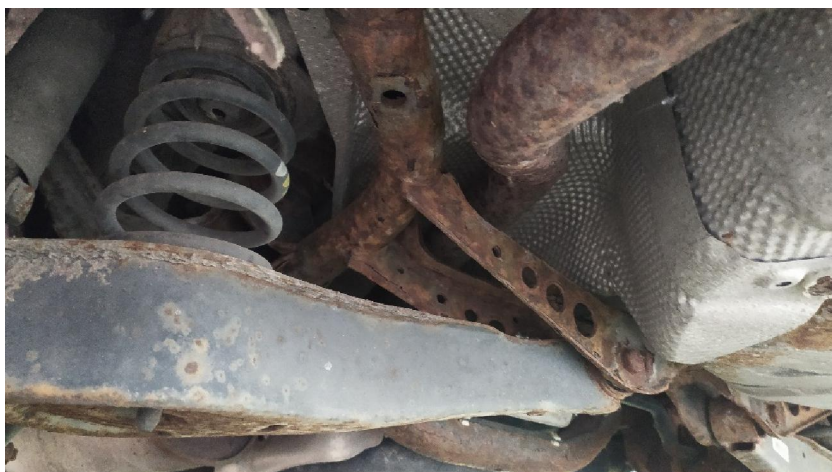
Obr.8a,b,c Zavěšení zadní nápravy
