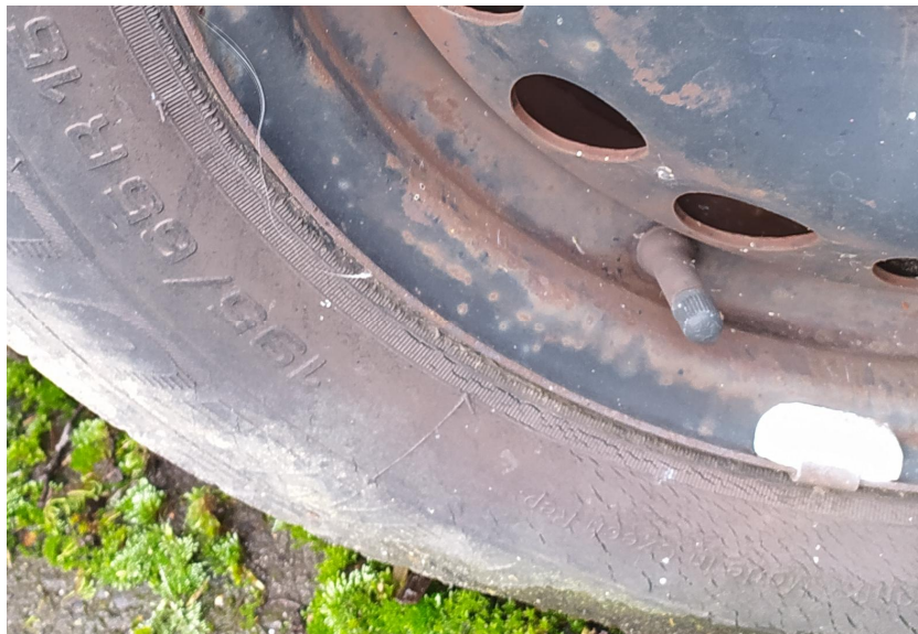
Obr.5a,b Pravá přední pneu, rozměr a na bočnici patrné praskliny. Stav ostatních pneumatik srovnatelný
